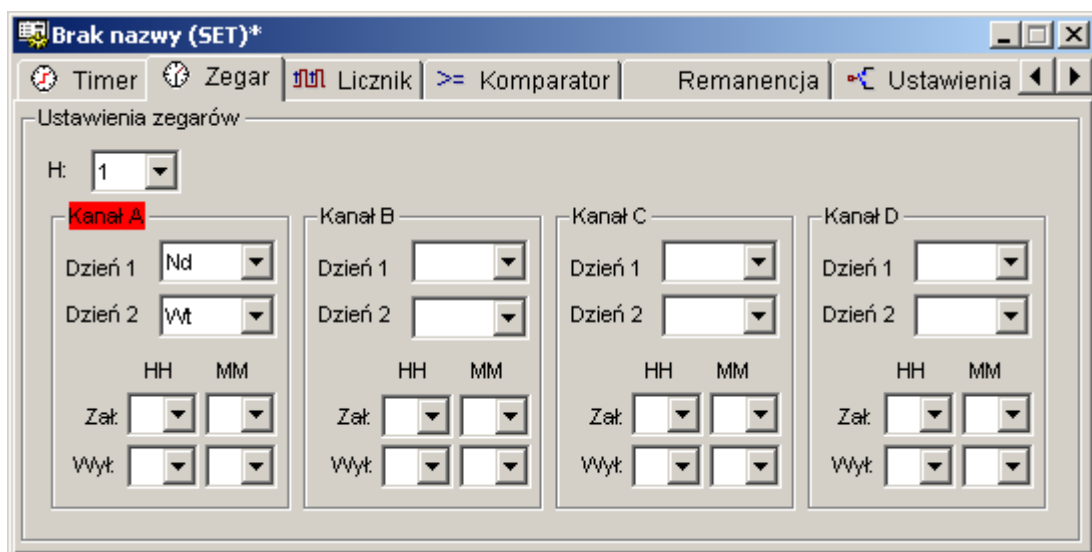
Rys. 4.9.2.2.1. Przykładowa konfiguracja Zegara – niewypełnione pola „Zał” i „Wył”.
